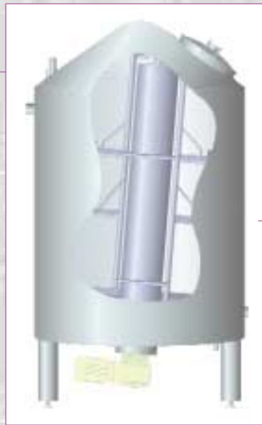
Kristallisationstank mit unten angetriebenem Rührwerk
